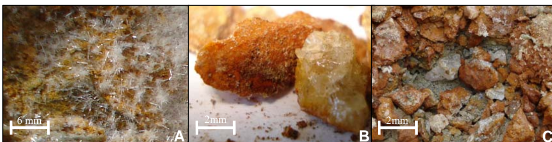
Figura 38. Fotos dos minerais neoformados na superfície do quartzo, misturado ao substrato, após drenagem da pilha. A. Cristais de sulfato formado na superfície da pilha; B-C. Impregnações ferruginosas pouco cristalinas na superfície do quartzo.
