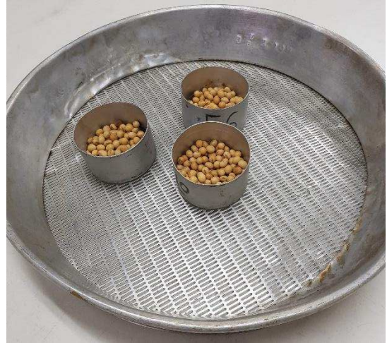
Figura 10 – Amostras de soja inseridas na estufa com circulação forçada de ar a 105 °C.
