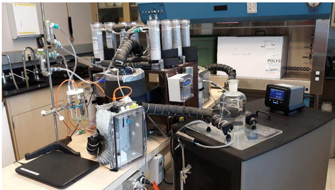
Figura 6 – Cilindros dos sistemas dinâmicos de respiração contendo material dessecante e absorvente de CO 2 .
