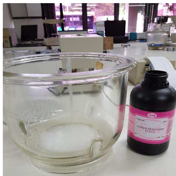
Figura 4 – Dessecador de vidro e solução salina saturada.
