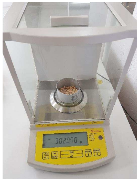
Figura 8 – Pesagens consecutivas das amostras de soja em balança analítica digital.
