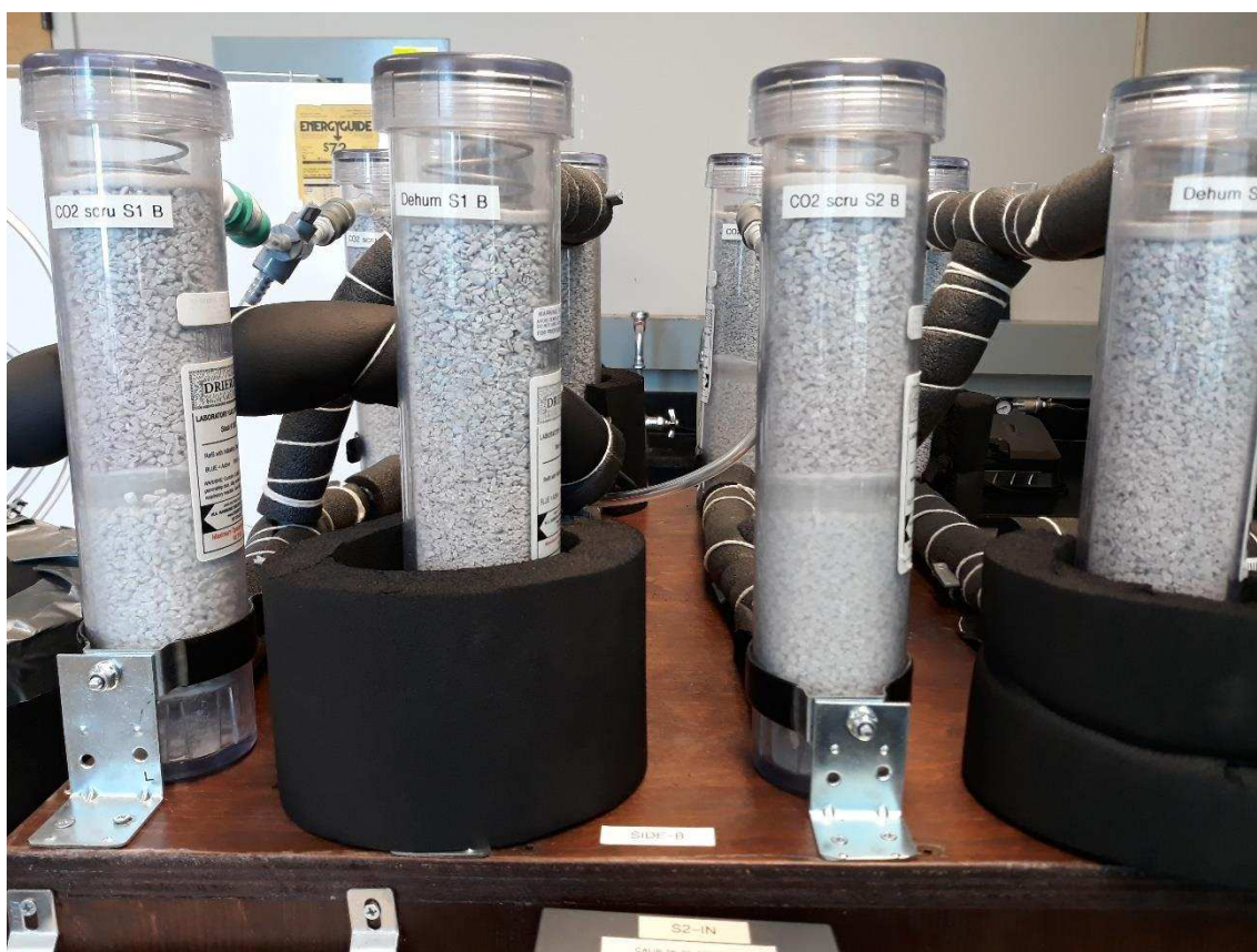
Figura 6 – Cilindros dos sistemas dinâmicos de respiração contendo material dessecante e absorvente de CO 2 .
