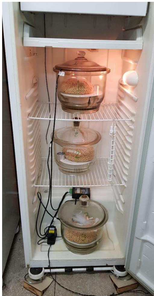
Figura 6 – Dessecadores armazenados na B.O.D.
