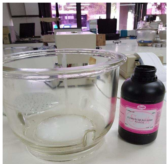
Figura 4 – Solução salina saturada depositada no fundo do dessecador de vidro.
