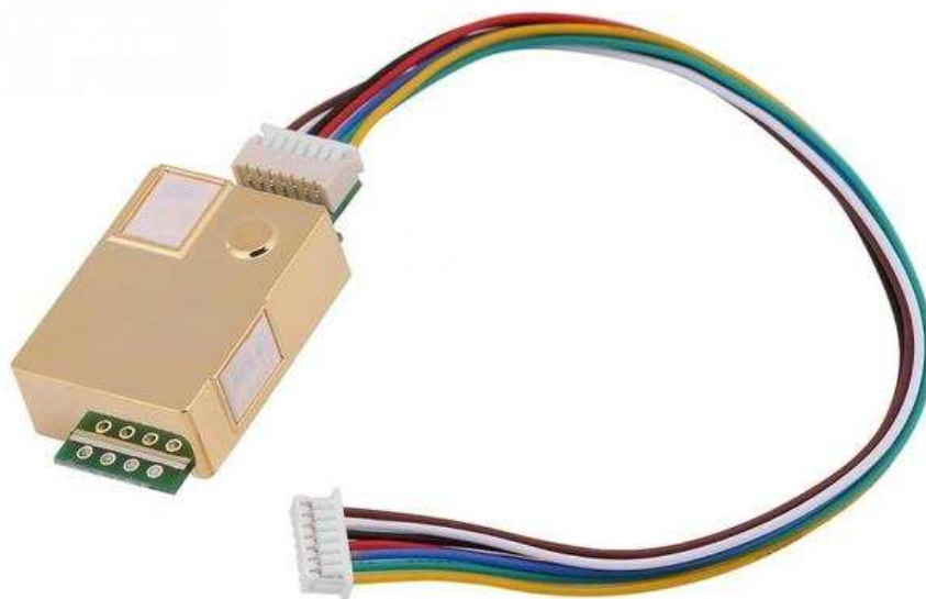
Figura 7 – Sensor de CO 2 infravermelho MH-Z19.
