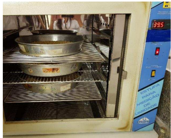
Figura 2 – Secagem artificial dos grãos de soja para determinação das isotermas de adsorção.
