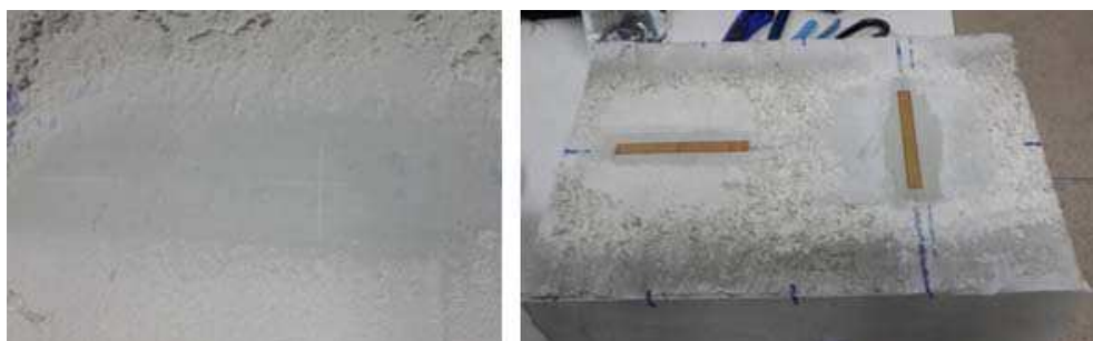
Figura 3-9 – Bloco com a superfície lixada com sua marcação e extensômetros aplicados
