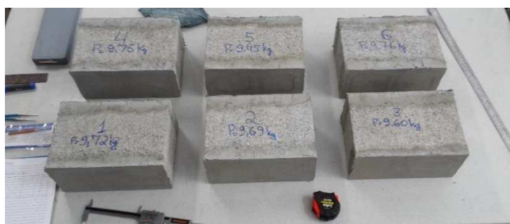
Figura 3-7 – Blocos preparados para instrumentação
