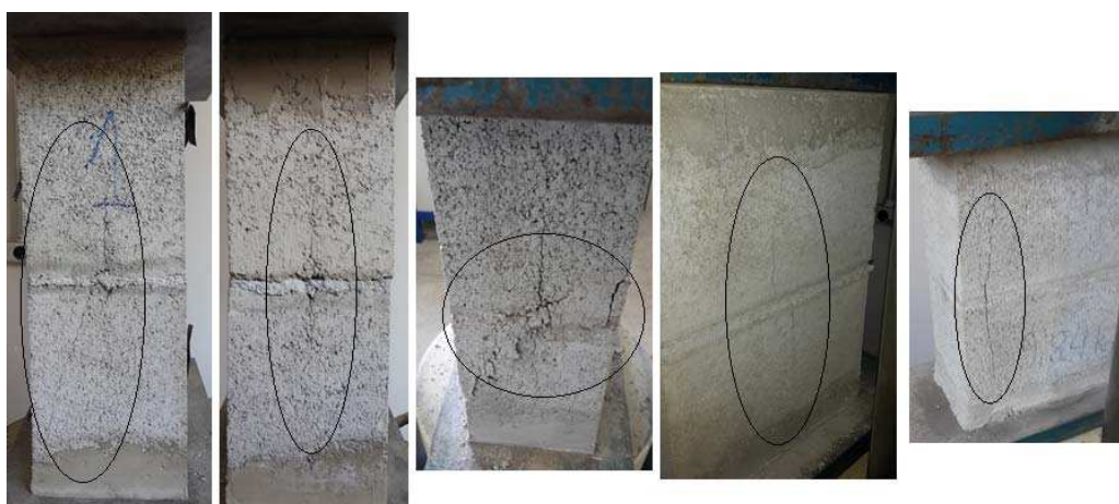
Figura 4-7 Modo de ruptura do prisma – Série 2 (argamassa – traço 2)
