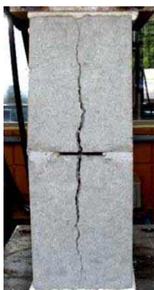
Figura 4-9 Modo de ruptura do prisma – Série 4 (argamassa parcial – traço 2)
