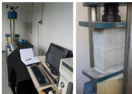
Figura 3-23 – Prensa EMIC e bloco posicionado para ensaio
