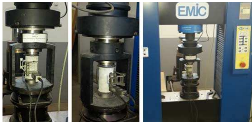
Figura 3-31 – Configuração do ensaio de módulo de elasticidade estático
