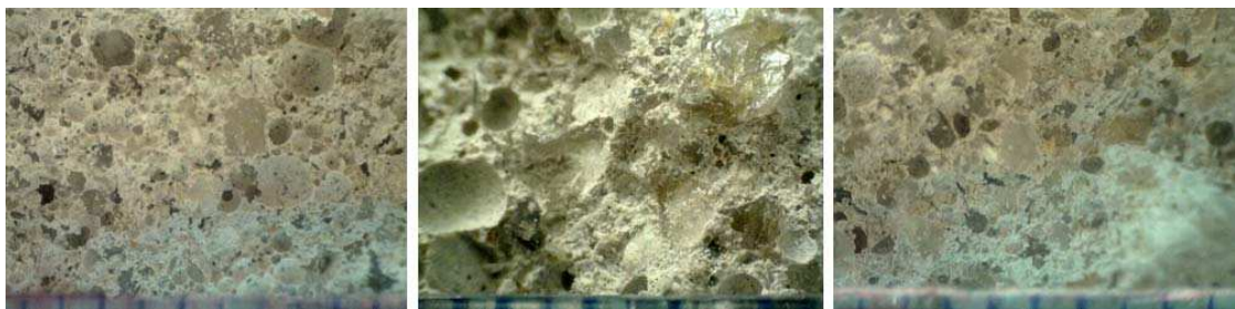
Figura 4-5 – Microscopia da argamassa – Traços 1, 2 e 3 respectivamente. Ampliação de 5 vezes.
