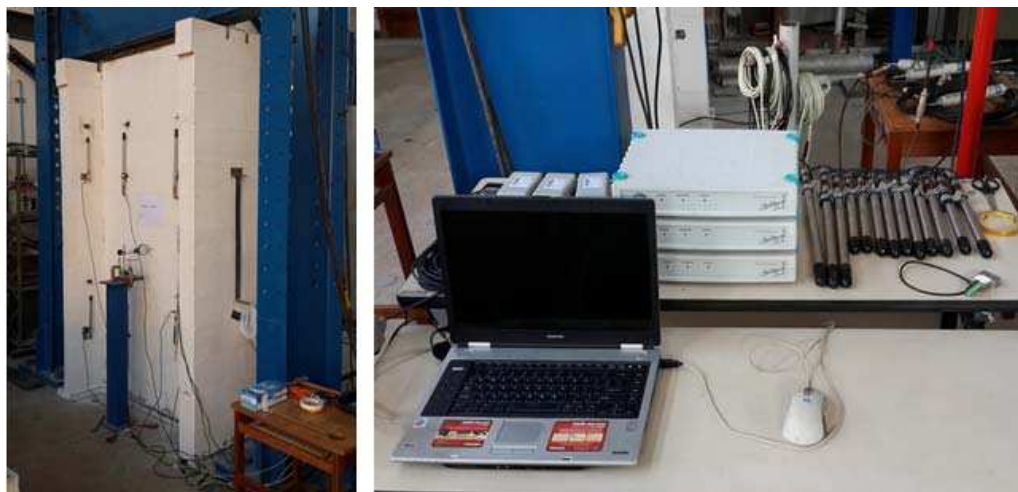
Figura 3-44 – Painel instrumentado e sistema de aquisição de dados
