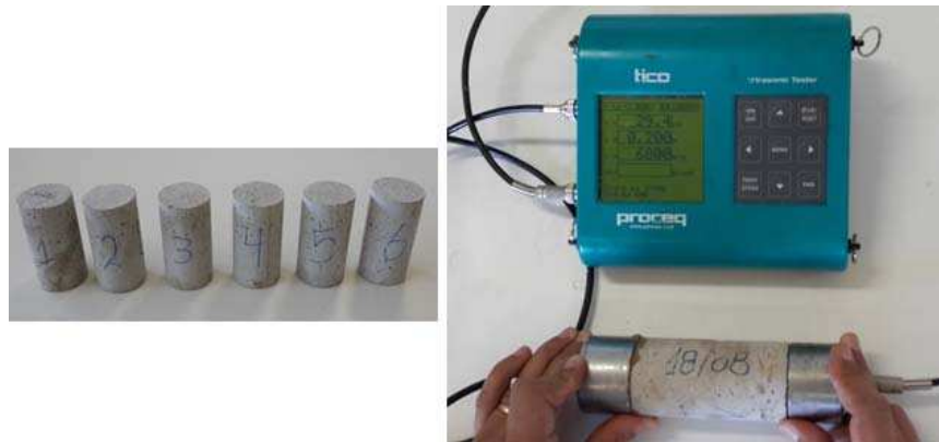
Figura 3-29 – Ensaio de módulo de elasticidade dinâmico em argamassa
