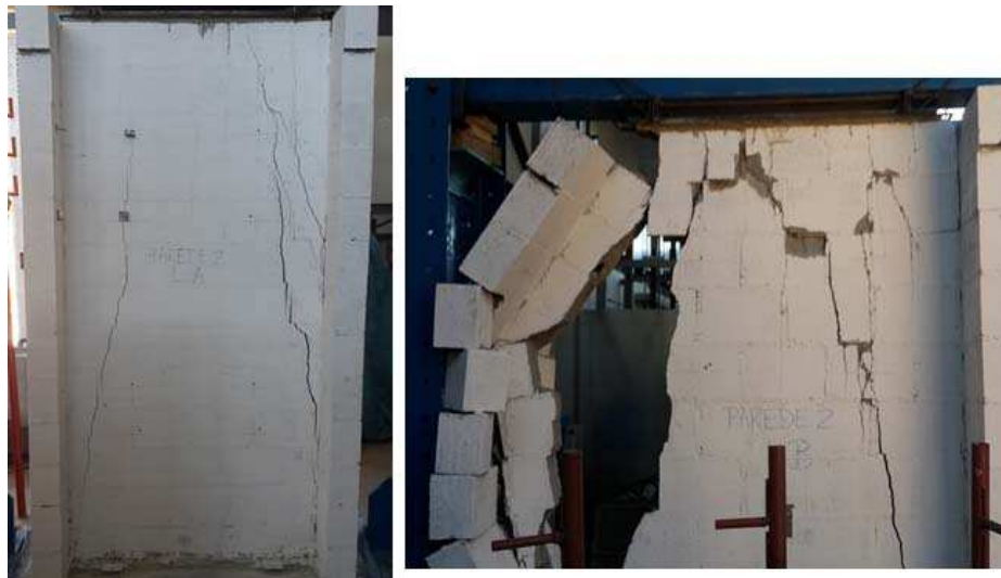
Figura 4-17 – Abertura de fissura na alma e ruptura no local de aplicação de carga (Painel 2)
