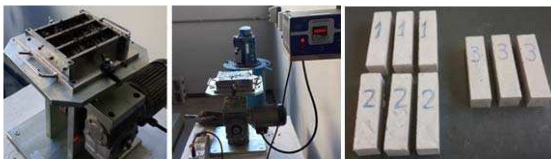
Figura 3-18 – 1) Molde metálico – 2) Moldagem dos corpos de prova de argamassa – 3) Corpos de prova prismático
