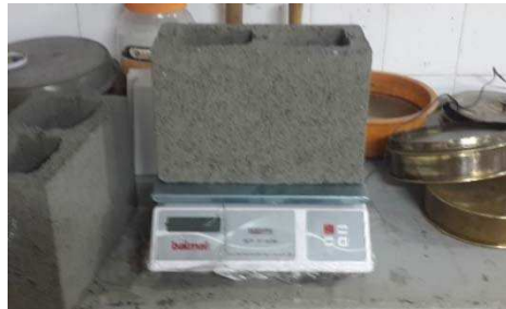
Figura 3-4 – Bloco pesado na condição de saturado superfície seca para obter ( m_2 )
