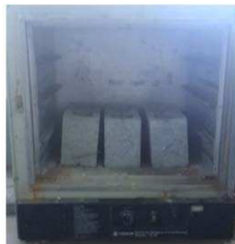
Figura 3-3 – Blocos colocados na estufa para a determinação da massa seca ( m_1 )
