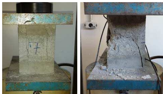
Figura 4-2 –Modos de ruptura do bloco padrão, (a) fissura vertical e (b) tronco cônica
