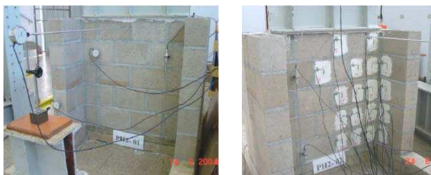
Figura 2-37 – Instrumentação das paredes com LVDT e extensômetros
