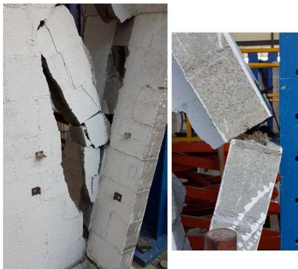
Figura 4-23 - Fissuras na alma e despreendimento da aba (Painel 4)
