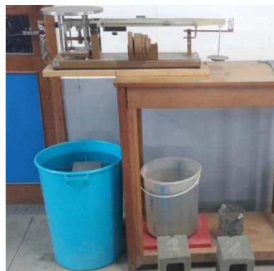
Figura 3-5 – Bloco colocado na balança hidrostática para determinação da massa aparente ( m_4 )
