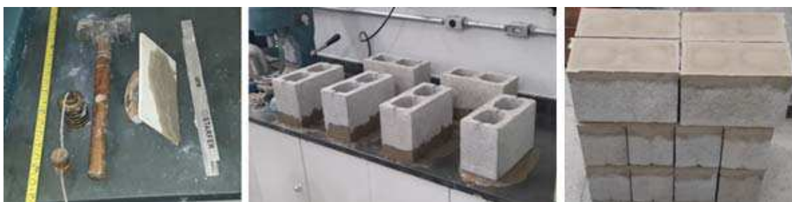
Figura 3-6 – Blocos sendo capeados e equipamentos utilizados
