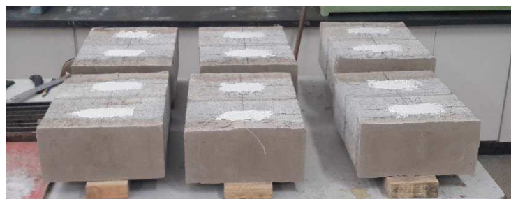
Figura 3-24 – Prismas sendo preparados para caracterização
