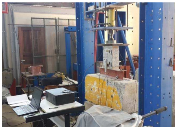
Figura 3-28 – Configuração do ensaio em prismas
