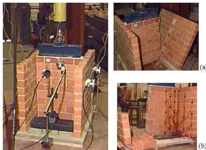
Figura 2-29 – Esquema de carregamento e formas de ruptura (CAMACHO, 2001)
