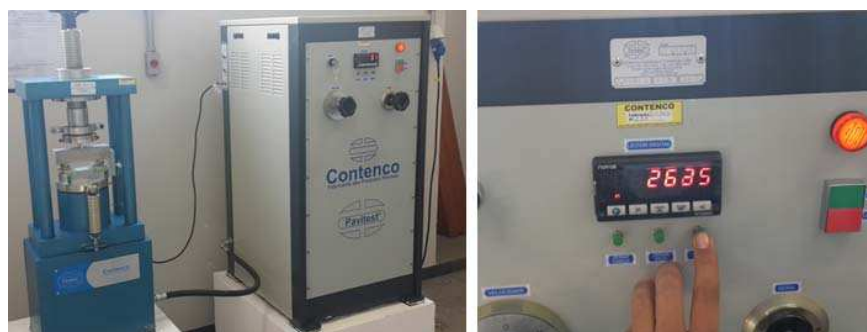
Figura 3-20 – 1) Prensa para ensaio em argamassa 2) Visor com apresentação de valor máximo
