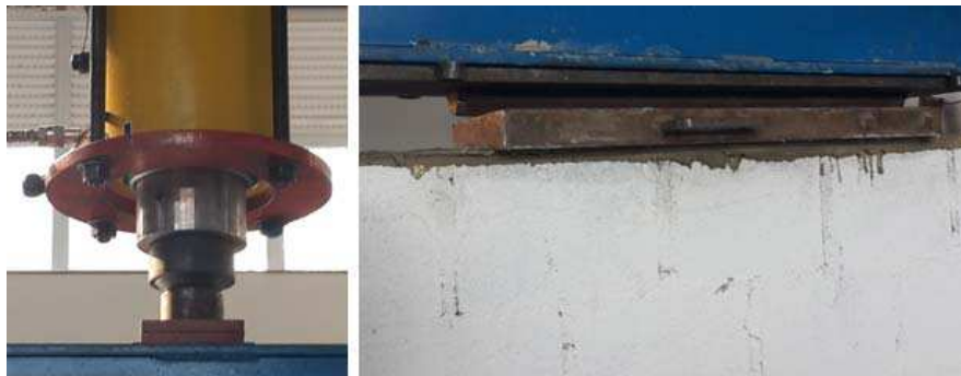
Figura 3-42 –Rótulas utilizadas no ensaio dos painéis
