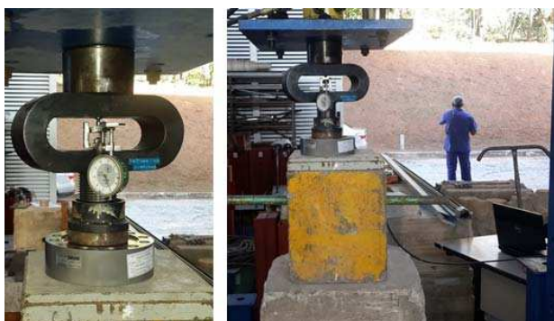
Figura 3-11 – Calibração da célula de carga com anel dinamométrico
