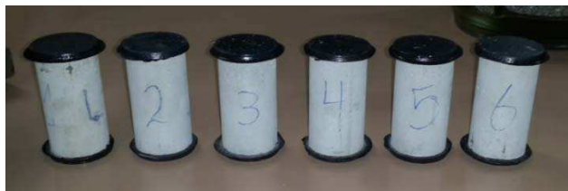
Figura 3-30 – Corpos de prova de argamassa capeados
