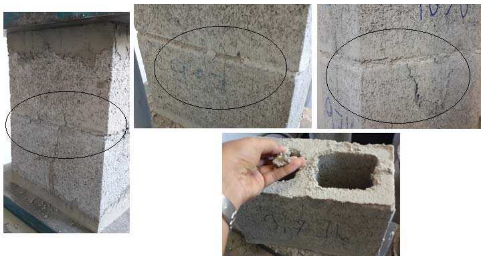
Figura 4-6 Modo de ruptura do prisma – Série 1 (argamassa – traço 1)
