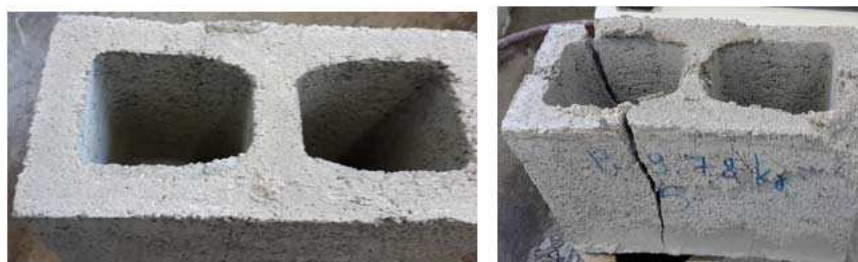
Figura 4-8 Modo de ruptura do prisma – Série 3 (argamassa – traço 3)
