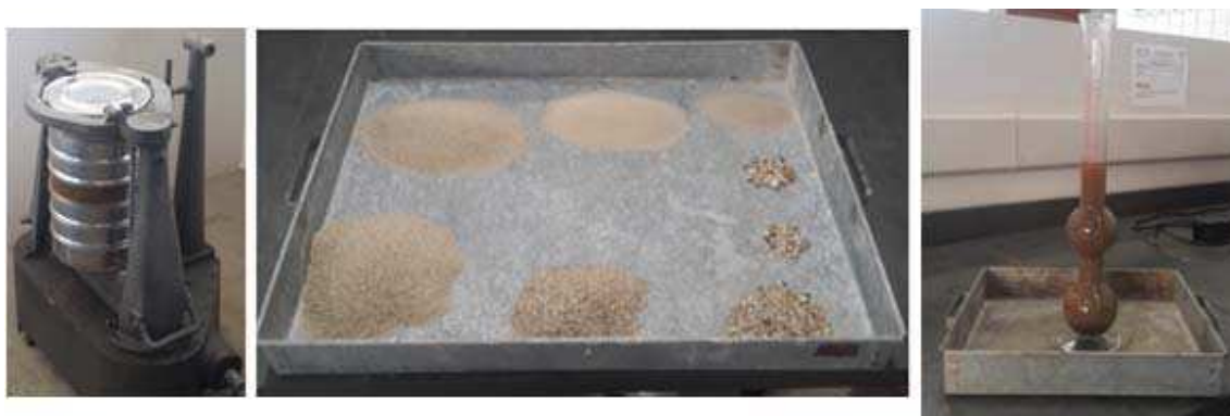
Figura 3-17 – Ensaio de granulometria e massa específica no agregado miúdo
