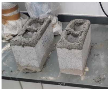
Figura 3-21 – Detalhe do argamassamento total
