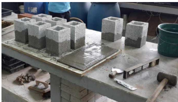
Figura 3-15 – Capeamento dos meio blocos
