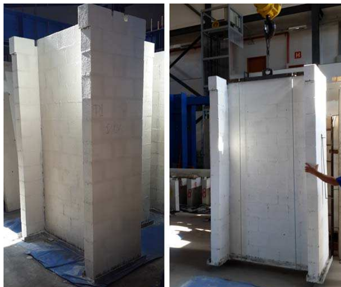
Figura 3-38 –Painel de alvenaria executado e sendo transportado
