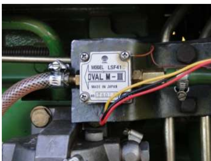
Figura 7. Fluxômetro utilizado para determinação do consumo de combustível.
