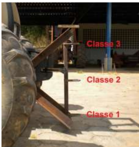
Figura 3. Estrutura utilizada para variação do ângulo de aplicação da força.
