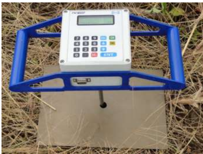
Figura 4. Vista frontal do penetrômetro utilizado.
