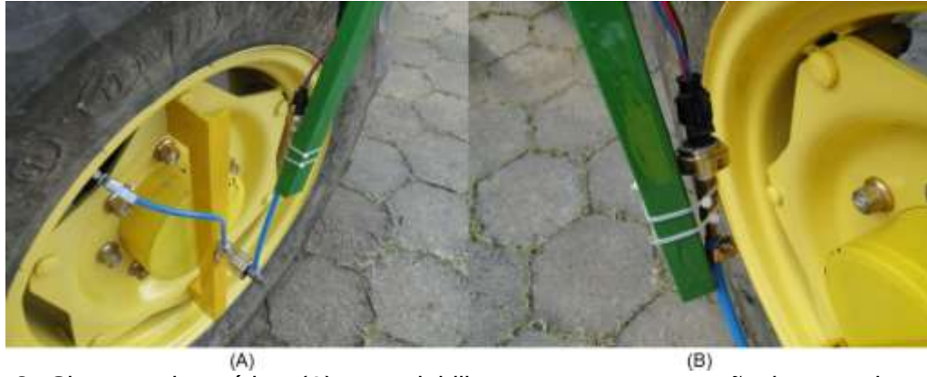
Figura 3. Sistema cinemático (A) que viabiliza mensurar a pressão interna do pneu em movimento. Detalhe do transdutor de pressão (B) utilizado nos testes.
