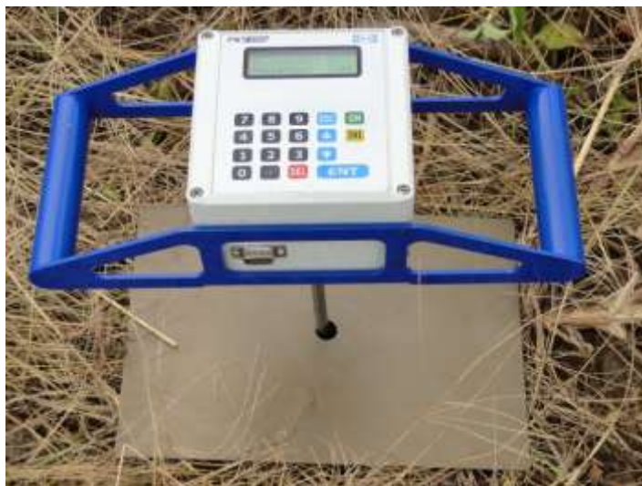
Figura 3. Vista frontal do penetrômetro utilizado.
