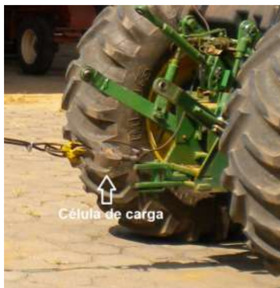
Figura 6. Posicionamento da célula de carga entre o cabo de aço e a barra de tração.
