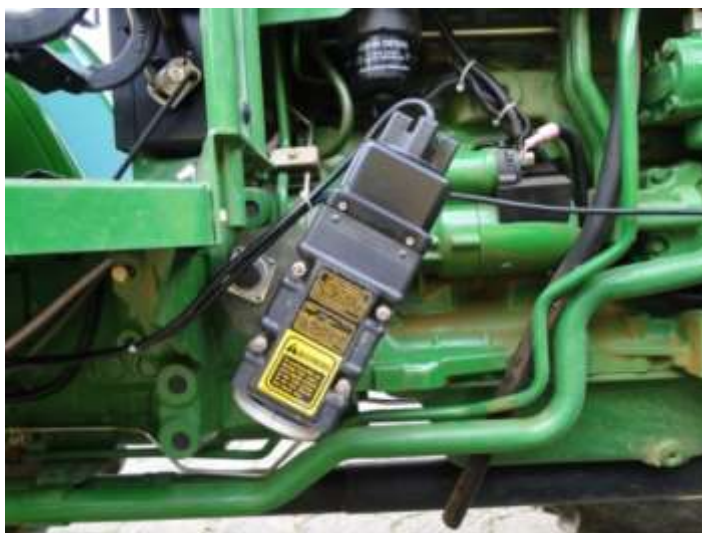
Figura 5. Unidade de radar utilizado para medição da velocidade instantânea.
