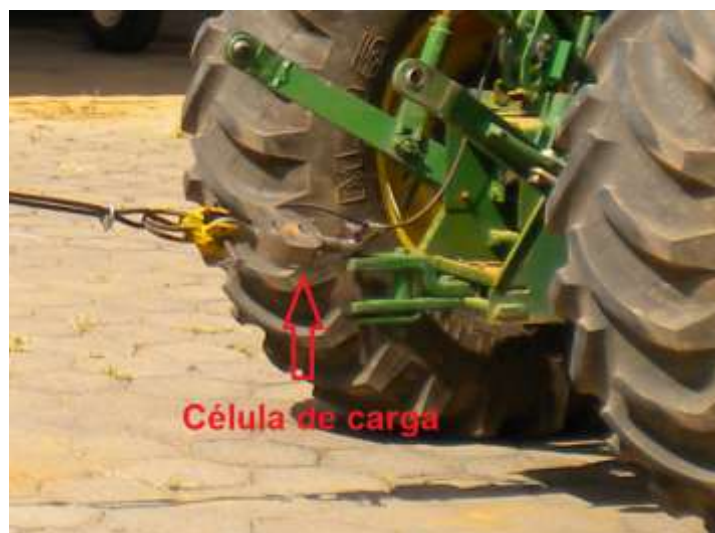
Figura 7. Posicionamento da célula de carga entre o cabo de aço e a barra de tração.
