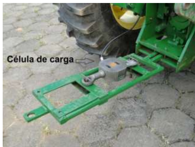
Figura 2. Célula de carga e estrutura suporte para a instalação no trator.
