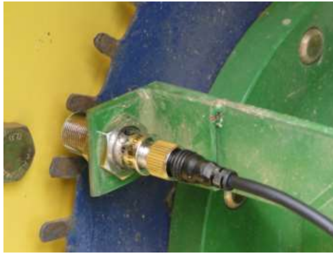
Figura 5. Sensor indutivo utilizado para a determinação da velocidade angular dos rodados.
