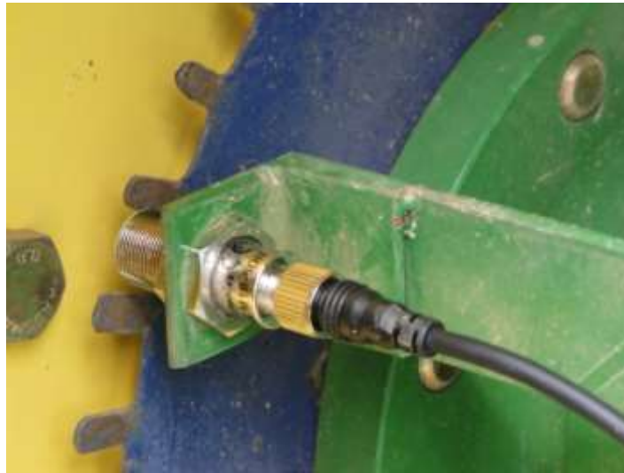
Figura 6. Sensor indutivo utilizado para a determinação da rotação dos rodados.
