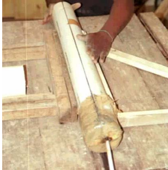
Figura 3. Detalhe mostrando os cortes longitudinais feitos nas colunas de PVC.
