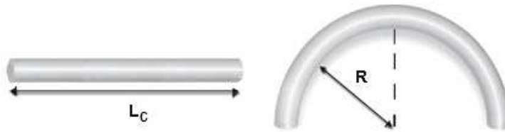
Figura 3.9: Curvatura de haste rígida. A haste inicialmente retilínea é deformada em um semicírculo. Extraída da referência [34].
