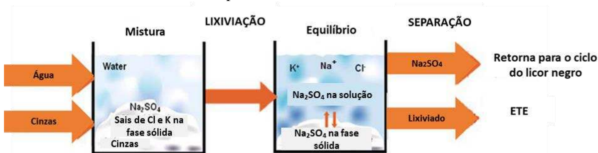
Figura 1.2 – Fluxograma simplificado das etapas da lixiviação das cinzas, compostos obtidos e destino do lixiviado e \text{Na}_2\text{SO}_4 recuperado
