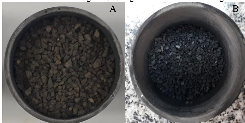
Figura 2.5 – Grânulos de lodo biológico (A) e grânulos de lodo biológico carbonizados (B)
