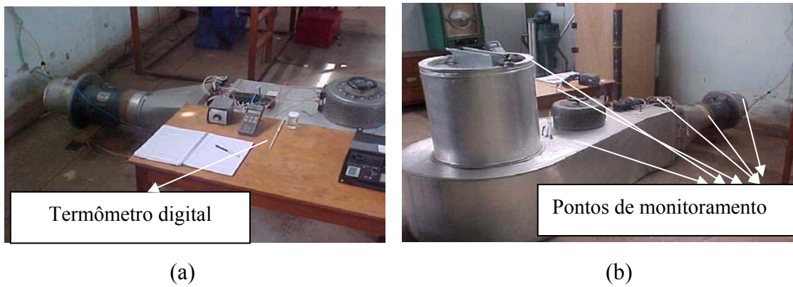
Figura 9 – (a) Detalhe do termômetro digital para o monitoramento da temperatura; - (b) Pontos de monitoramento da temperatura.
