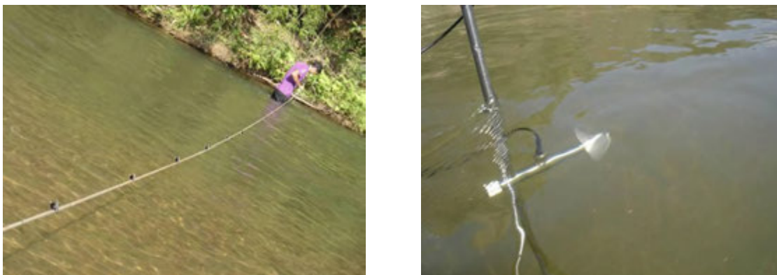
Figura 12. Medição das velocidades nas verticais das seções transversais em estudo.
