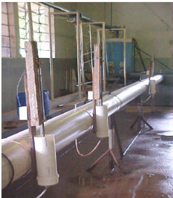
Figura 6 – Vista dos três linímetros instalados ao longo do canal.
