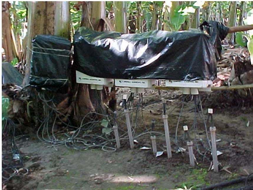
FIGURA 3C – Detalhe da instalação das caixas multiplexadoras e dos extratores de solução do solo, em campo.
