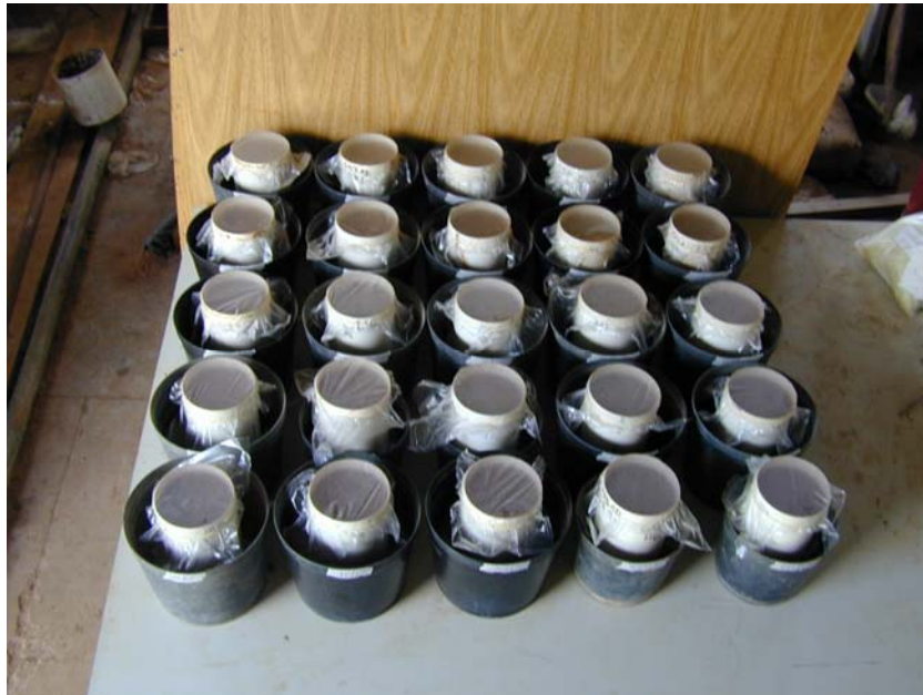
FIGURA 1B – Colunas de solo cobertas e em repouso, visando evitar perda de água por evaporação e assegurar melhor distribuição da solução de cloreto de potássio nas colunas de solo.
