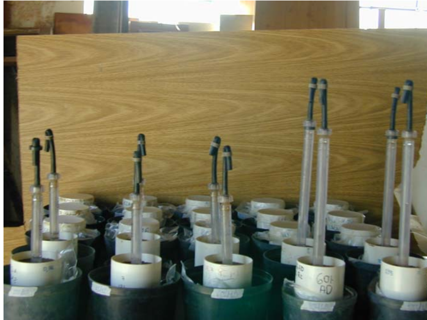
FIGURA 3B – Colunas de solo contendo extratores de solução do solo, a fim de monitorar a condutividade elétrica da solução do solo e a concentração de potássio da solução do solo.
