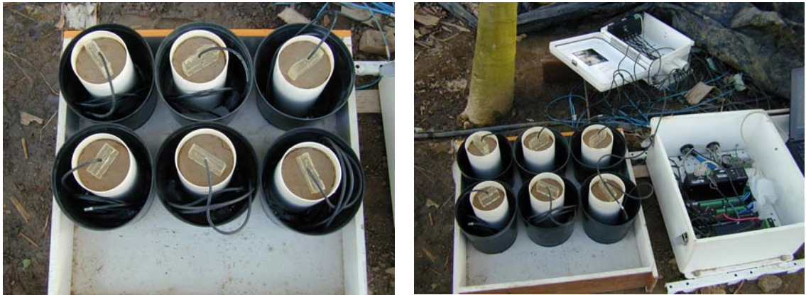
FIGURA 1A – Colunas de solo utilizadas para calibrar o equipamento de TDR para leitura de teor de água no solo: (A) vista aproximada das colunas de solo com as sondas de TDR inseridas no solo (B) equipamento de TDR fazendo de leituras de teor de água no solo.
