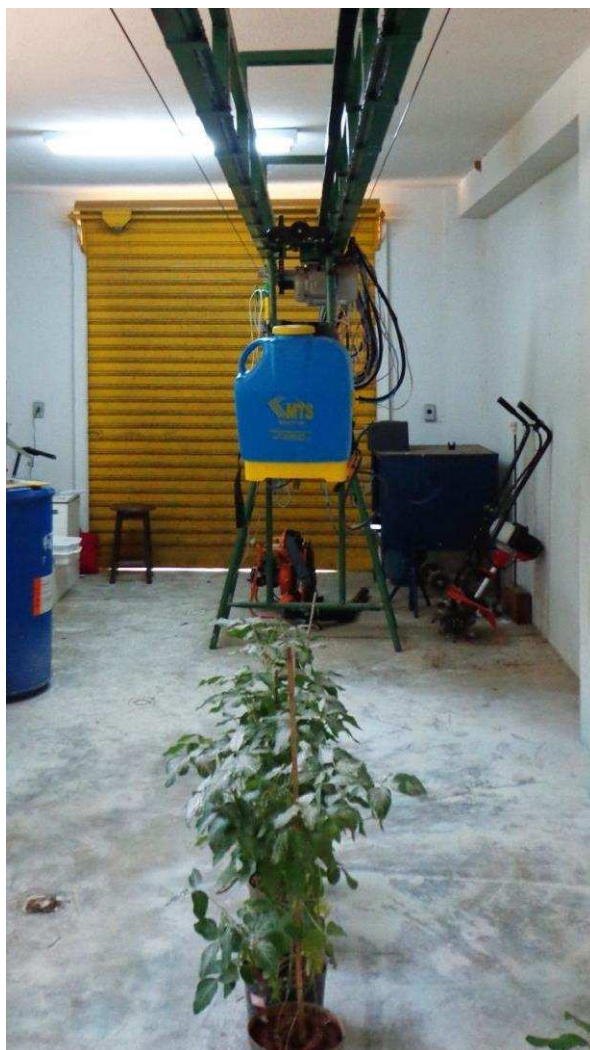
Fig. 1 - Pulverizador montado em trilho deslizante e plantas de soja no estágio R4 após receber pulverização de calda contendo caulim 6%.
