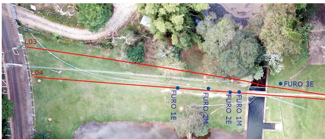
Figura 54: Pontos onde foram realizados os ensaios SPT.
