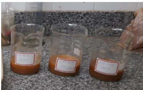
Figura 59: Material tomado para sedimentação, mantido em repouso em solução de hexametáfosfato de sódio.
