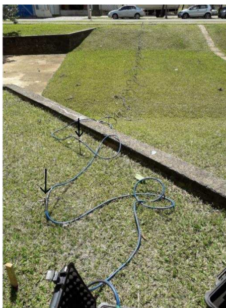
Figura 39: Eletrodos posicionados em uma das linhas de investigação.
