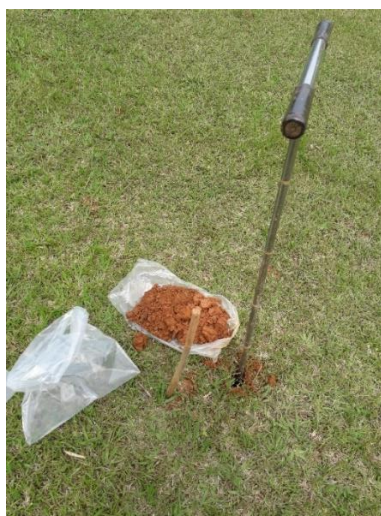
Figura 58: Equipamentos utilizados na campanha de sondagens a trado.
