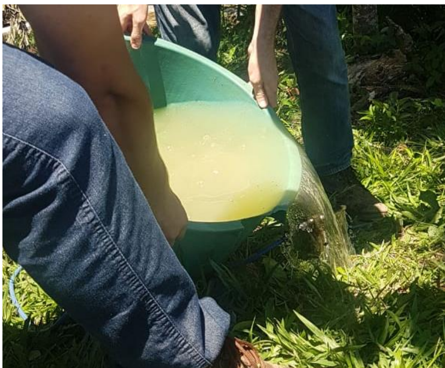
Figura 41: Aplicação da solução salina nos eletrodos.
