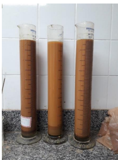
Figura 60: Material transferido para a proveta, para a execução das leituras do densímetro.
