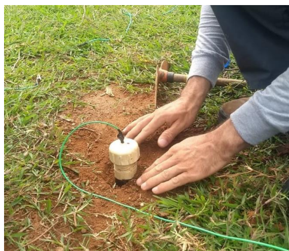
Figura 47: Posicionamento do eletrodo fixo.
