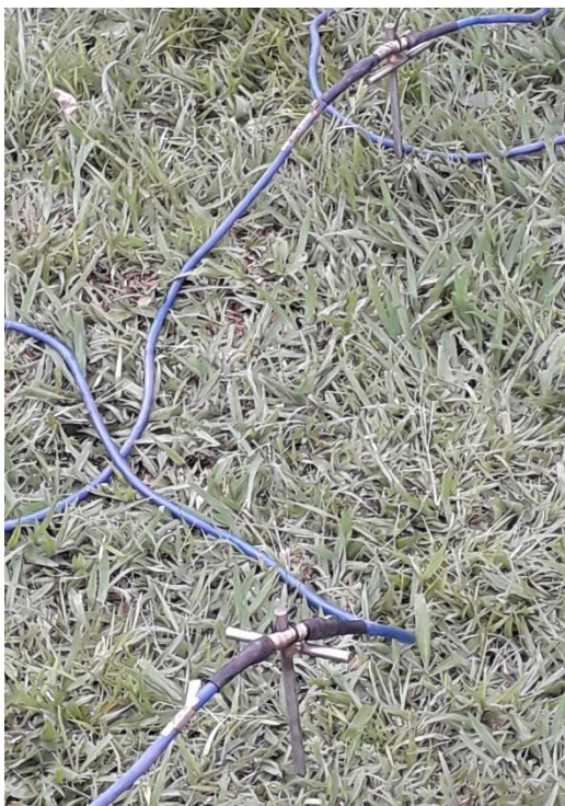
Figura 40: Detalhe dos eletrodos cravados no solo.
