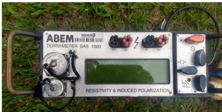
Figura 45: Resistivímetro usado na medição do potencial espontâneo.
