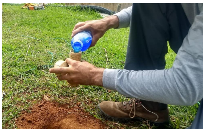
Figura 46: Preparação dos eletrodos não polarizados.
