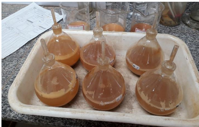
Figura 61: Dispersão de solo transferida para o picnômetro, para determinação da massa específica dos sólidos.
