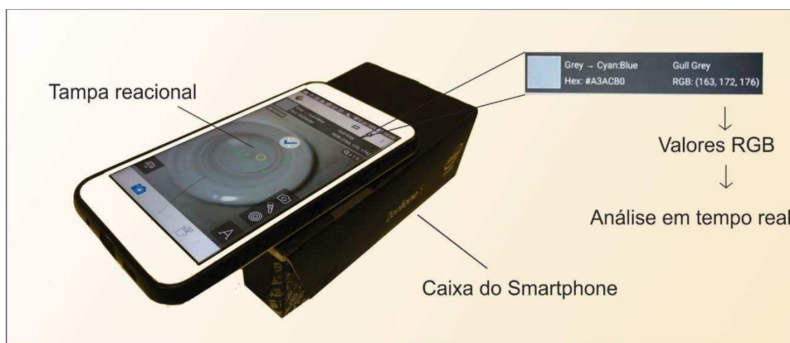
Figura 51 – Aparato desenvolvido para determinação de Cu(II) em amostras de cachaça.
