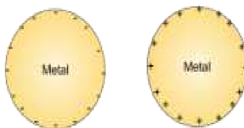
Figura 6 - Distribuição das cargas elétricas em um condutor metálico carregado e em equilíbrio eletrostático
