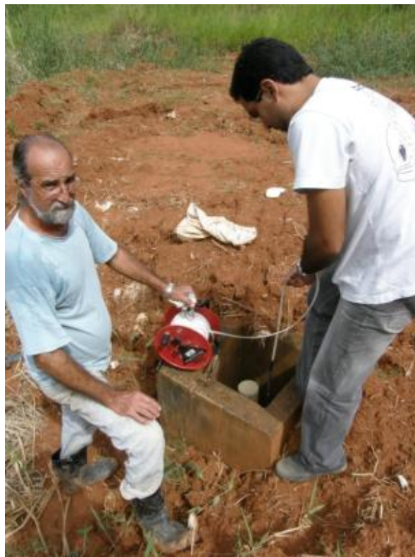
Figura 4.2 – Medição do nível freático utilizando o “apito”.
