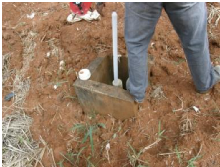
Figura 4.1 – Introdução do bailer no poço de amostragem.
