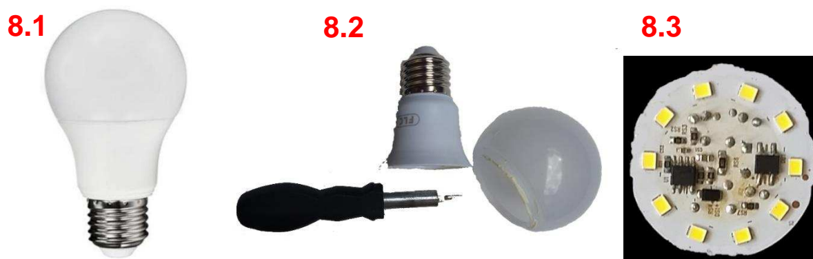
Figura 8. Lâmpada de LED (8.1), lâmpada desmontada (8.2) e placa integrada de LED (8.3).
