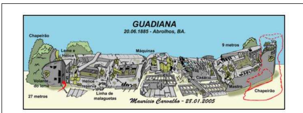
FIGURA 08: Desenho de Maurício Carvalho representando os destroços do Navio Guadiana, naufragado na região de Abrolhos. FONTE: SKAF 145 O navio tem 110 metros de comprimento e 12 metros de boca. O desenho apresenta as partes do navio e chapeirões em seu entorno.
