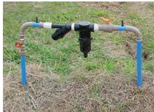
Figura 3B – Componentes (motobomba e componentes de filtragem) do sistema de irrigação utilizados na condução do experimento de maracujazeiro amarelo.
