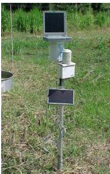
Figura 3 – Estação meteorológica automática instalada próxima à área experimental.
