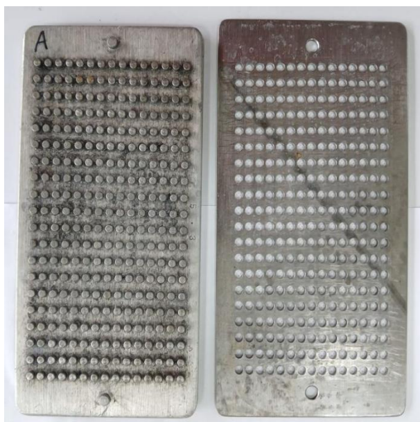
Figura 5. Placa compactadora usada na produção de misturas granuladas NPK.
