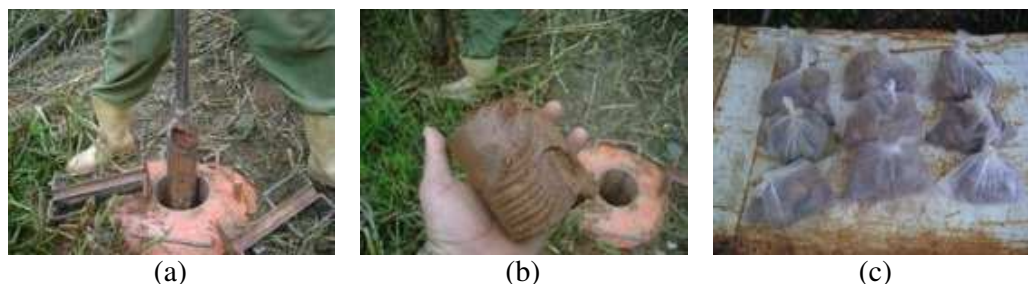
Figura 9 - Coleta de amostras deformadas nos furos de sondagem: (a) amostrador, (b) amostra deformada e (c) acondicionamento.
