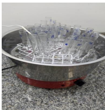
Figura 2.7- Tubos de ensaio contendo amostras de água dos pontos da rede de distribuição da ETA-UFV para quantificação de trihalometanos empregando o método espectrofotométrico
