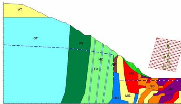
Figura A.3: Ruptura localizada na base do talude seção 1 utilizando o Slope/W
