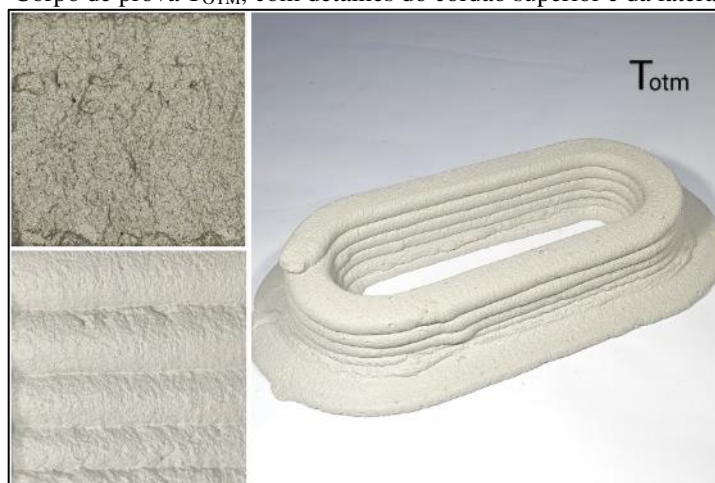
Figura 2.14 – Corpo de prova T_{OTM} , com detalhes do cordão superior e da lateral das camadas.
