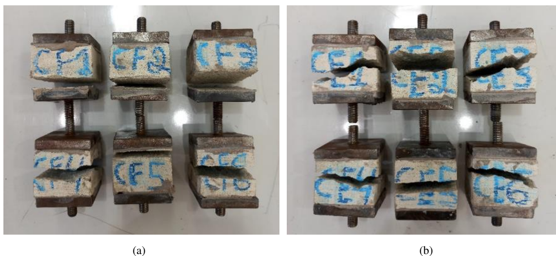
Figura 3.11 – Corpos de prova após a ruptura no ensaio de aderência entre camadas. (a) Corte no estado fresco; (b) corte no estado endurecido.
