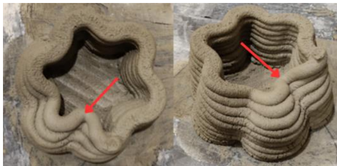
Figura 1.4 - Colapso local do objeto impresso.
