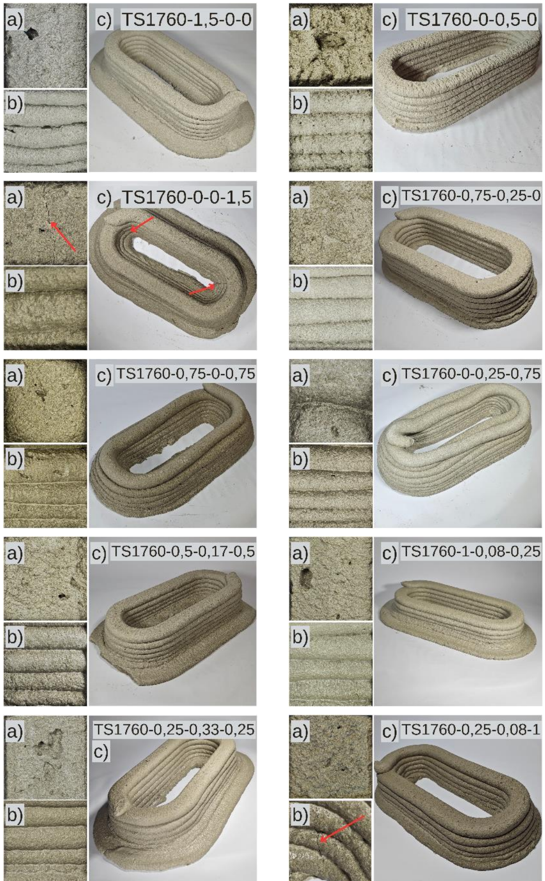
Figura 2.11 – Corpos de prova do estudo de aditivos com detalhe das camadas laterais e do filete de topo.
