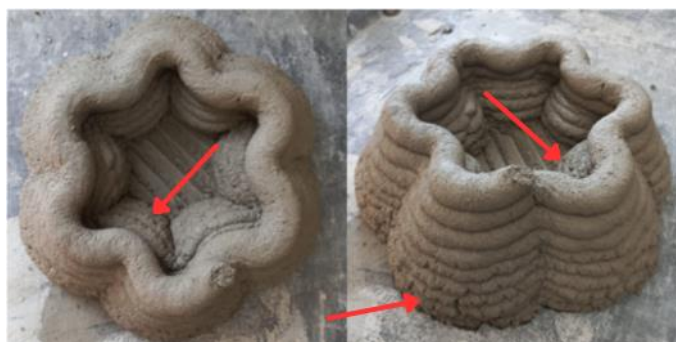
Figura 1.5 - Colapso global do objeto impresso.
