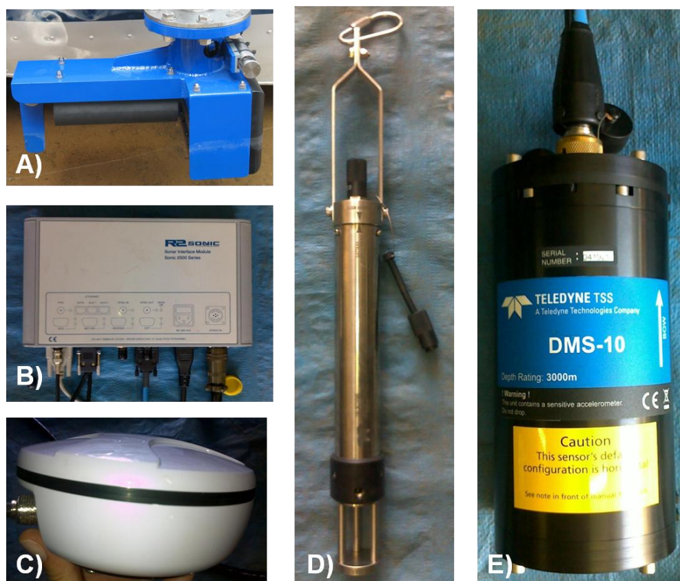
Figura 27 - Principais equipamentos utilizados na segunda batimetria: A) ecobatímetro multifeixe, B) sonar interface module , C) GPS, D) digibar e E) motion sensor .
