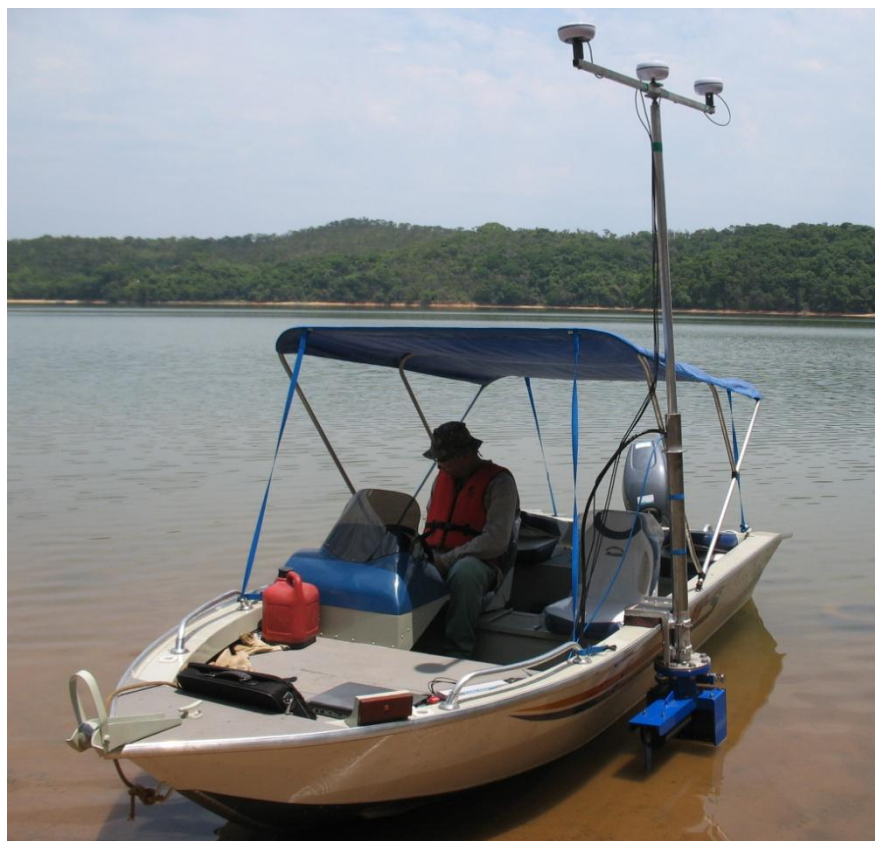
Figura 26 - Barco montado para a batimetria com o ecobatímetro multifeixe.
