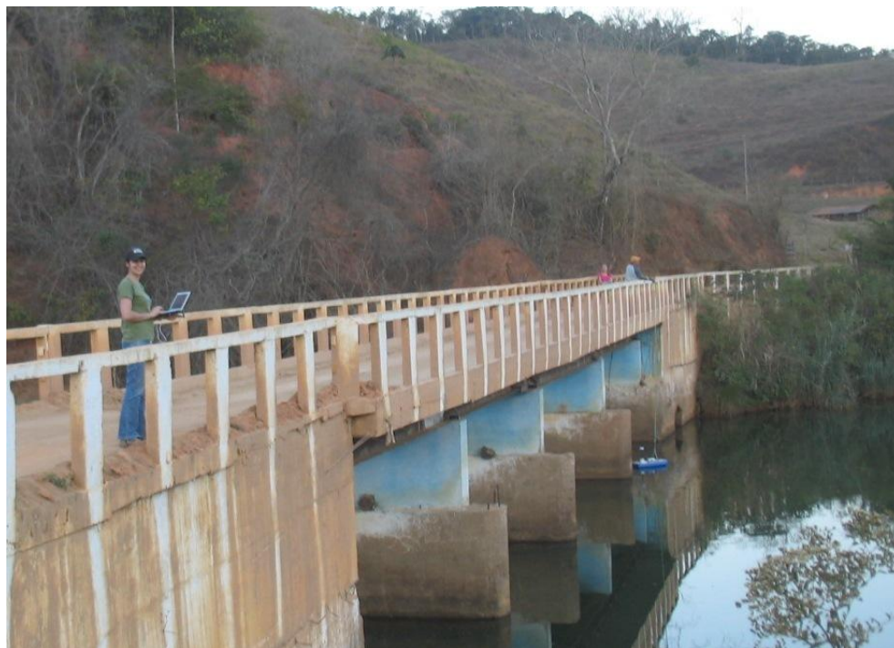
Figura 29 - Medição de vazão com ADCP.
