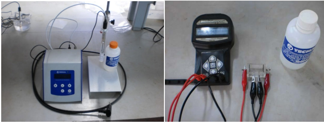
Figura 2: (a)-Condutivímetro de laboratório e (b)-Condutivímetro portátil LanMapper ERM02.
