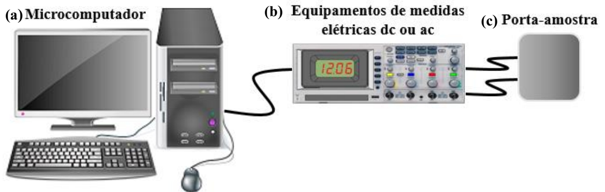
Figura 24 – Aparato experimental utilizado para a realização das medidas elétricas dc e ac. A figura mostra (a) um microcomputador acoplado aos (b) equipamentos de medidas dc ou ac que, por sua vez, encontrava-se conectado a um (c) porta-amostra onde é feito o contato elétrico.
