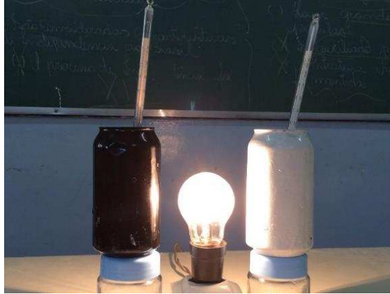
Figura 13 – Demonstração 1F: de propagação de calor por irradiação.
