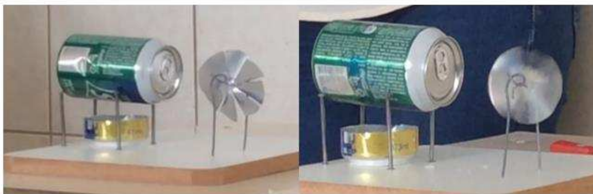
Figura 14: Máquina térmica construída com materiais de baixo custo.
