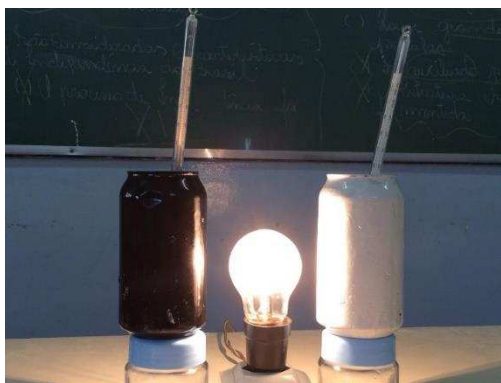
Figura 9: Demonstração de propagação de calor por radiação.
