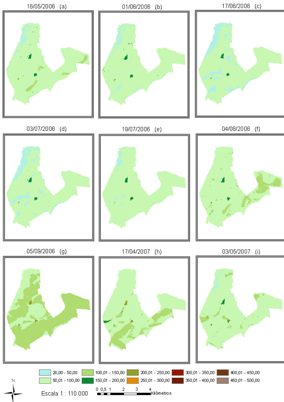
Figura 42 - Fluxo de calor no solo ( \text{W m}^{-2} ) da superfície territorial da fazenda Boa Fé, obtido por meio de imagens do sensor TM do Landsat 5 para as datas: (a) 16/05/2006, (b) 01/06/2006, (c) 17/06/2006, (d) 03/07/2006, (e) 19/07/2006, (f) 04/08/2006, (g) 05/09/2006, (h) 17/04/2007, (i) 03/05/2007.
