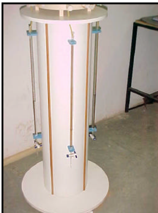
Figura 3.9 – Suporte para o equipamento com as buretas acopladas
