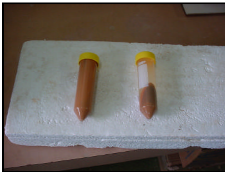
Figura 3.13 – Amostras antes (à esquerda) e após a centrifugação (à direita)
