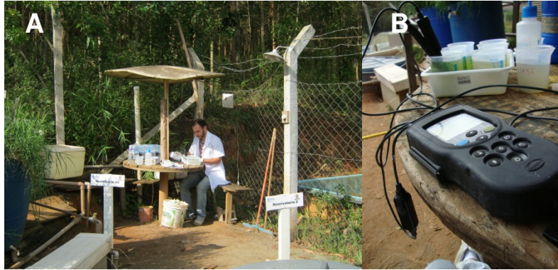
Momento de medição em campo das variáveis pH, temperatura, OD e condutividade (A); sonda utilizada (HACH-HQ40d) (B).
