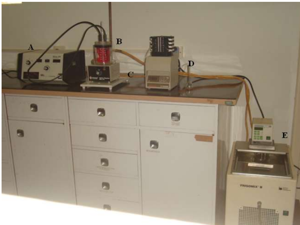
Figura 7. Sistema empregado para a degradação do Vermelho Congo. A - fonte de alta tensão; B - cela reacional; C - agitador magnético; D - bomba peristáltica; E - banho termostático.
