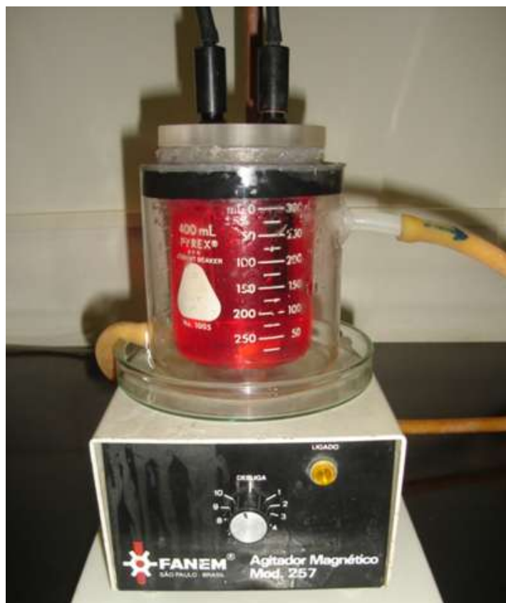
Figura 6. Cella utilizada para a degradação sob plasma.
