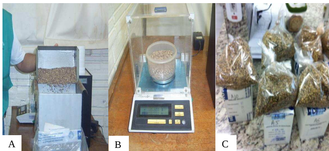
Figura 2. Homogeneização (quarteador) (A); Pesagem de 150 g da amostra de trabalho (B); Amostra armazenada (C)
