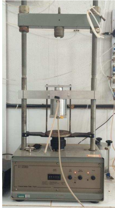
Figura 3.4. Bomba de fluxo adaptada na prensa triaxial.
