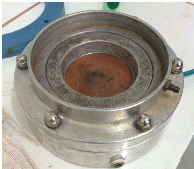
Figura 3.14. Célula de adensamento incremental montada com o rejeito.
