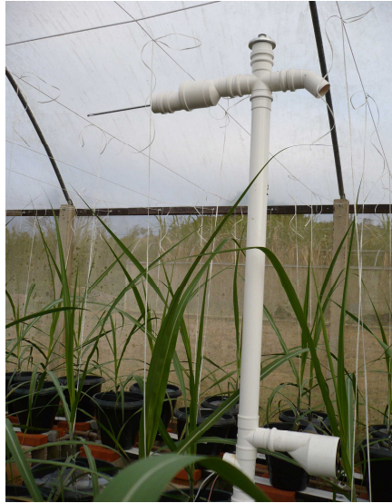
Figura 4.3. Vista do sistema de medição da radiação solar global incidente, temperatura, umidade relativa e velocidade do ar, instalado na estrutura em PVC, no interior da casa de vegetação.
