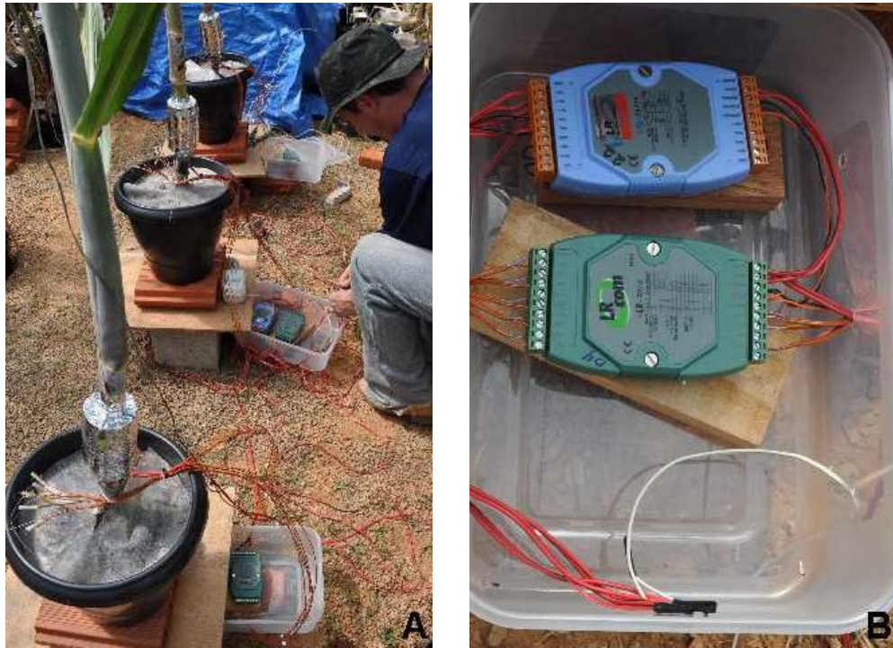
Figura 5A. Conexão dos termopares e dos condutores elétricos provenientes dos mini-resistores aos módulos de aquisição de dados para medição da temperatura da seiva e tensões elétricas aplicadas nos três sistemas de medição (A e B).
