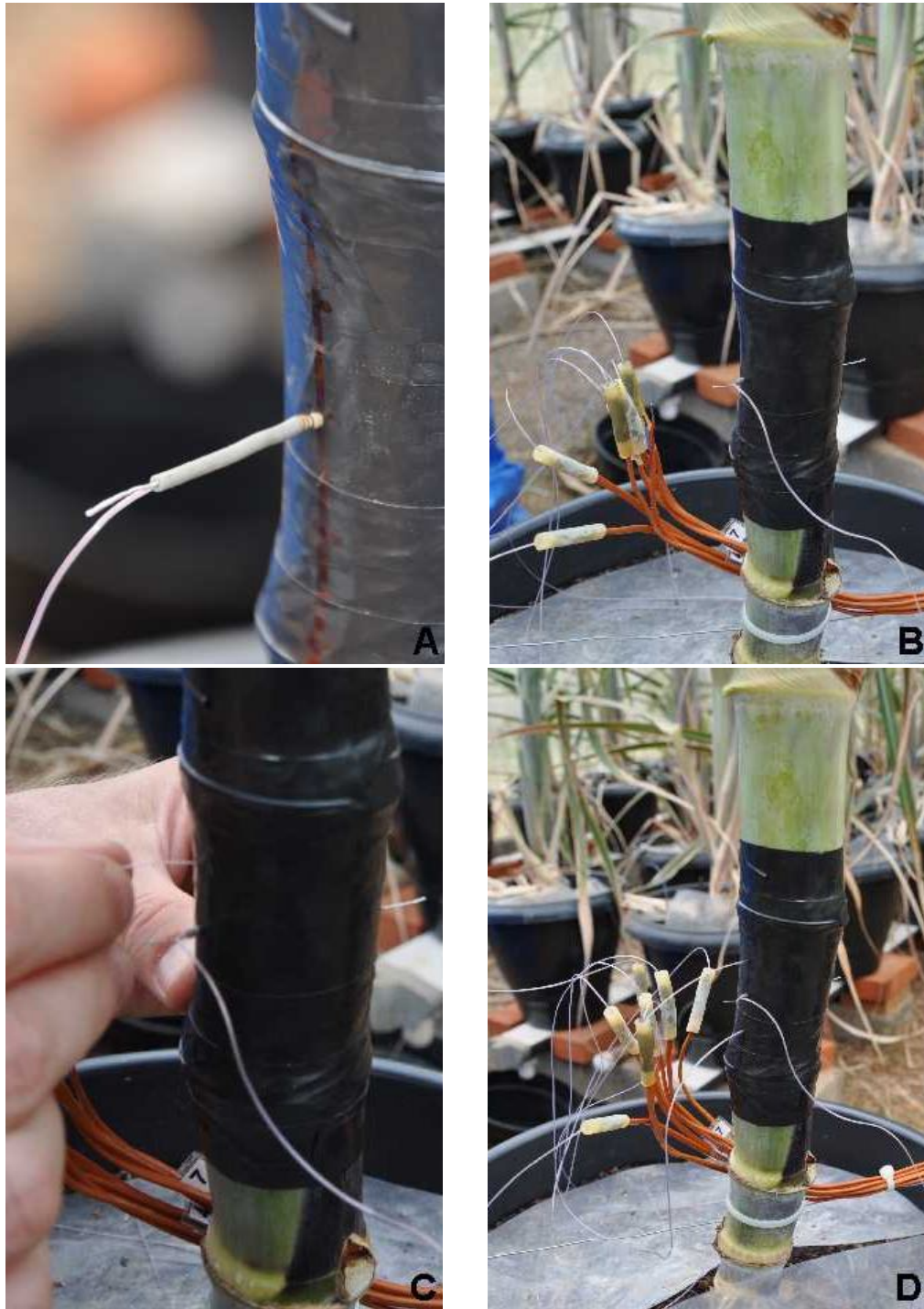
Figura 2A. Início (A) e término (B) da inserção do mini-resistor no centro do colmo, juntamente com um termopar, o qual foi posicionado no centro da área revestida pelas fitas adesivas; instalação de termopares para medição da temperatura da seiva 1,5 cm acima (C) e 1,5 cm abaixo (D) da fonte de calor proporcionada pelo mini-resistor.
