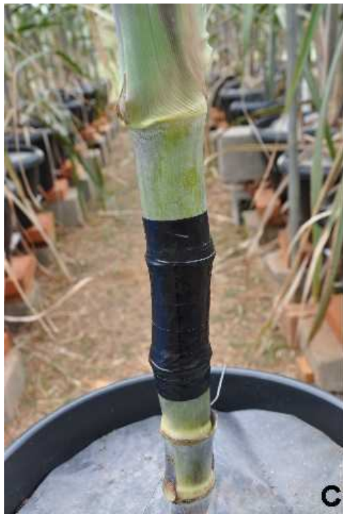
Figura 1A. Limpeza do colmo da planta de cana-de-açúcar (A); revestimento da superfície do colmo com fita adesiva de alumínio (B) e desta com uma fita isolante (C); perfuração transversal do colmo da planta com uma agulha para inserção do mini-resistor (D).
