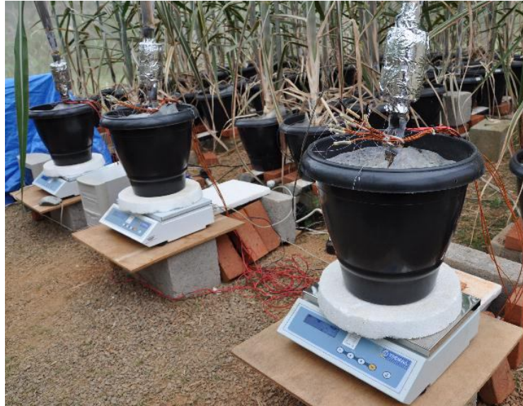
Figura 4.4. Sistemas individuais de pesagem para medição da transpiração e do fluxo de seiva da cana-de-açúcar instalados sob vasos de cultivo no interior da casa de vegetação.
