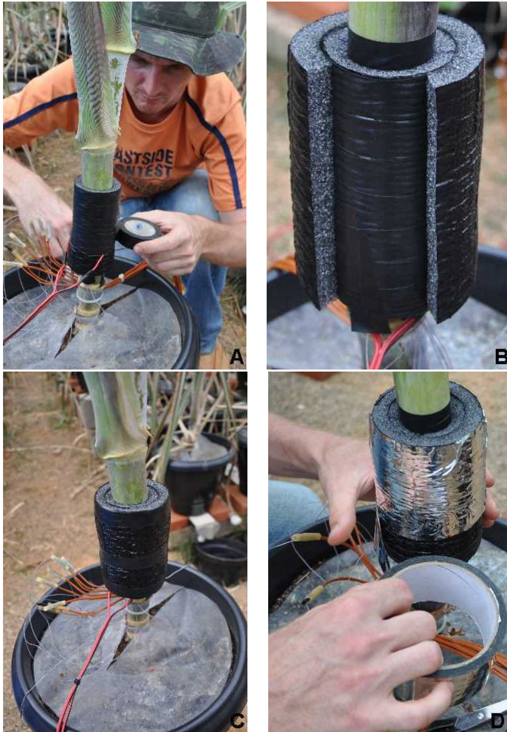
Figura 4A. Revestimento e amarração da 1ª camada da manta de isolamento térmico com uma fita isolante (A); colocação da 2ª camada da manta de isolamento térmico (B) e amarração com fita isolante (C); revestimento da manta de isolamento térmico com fita de alumínio para reflexão da radiação solar (D).
