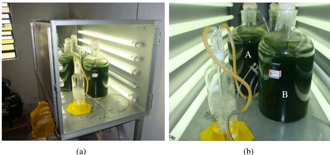
Figura 2. (a) Câmara de cultivo contendo os fotobiorreatores airlift e (b) detalhe nos fotobiorreatores airlift A e B, sistemas de injeção de ar, de iluminação e lavagem de gás.
