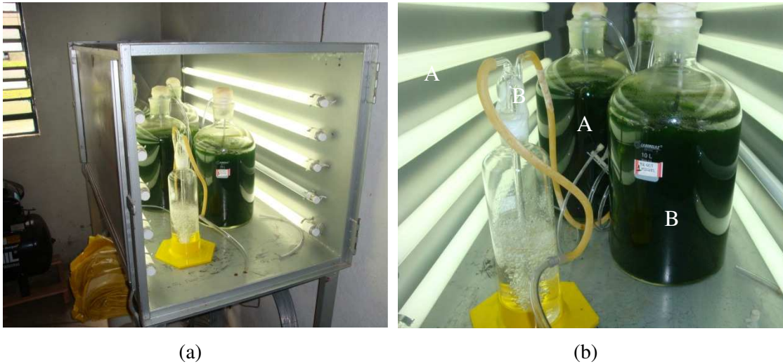
Figura 1. (a) Câmara de cultivo contendo os fotobiorreatores airlift e (b) detalhe nos fotobiorreatores airlift A e B, sistemas de injeção de ar, de iluminação e lavagem de gás.
