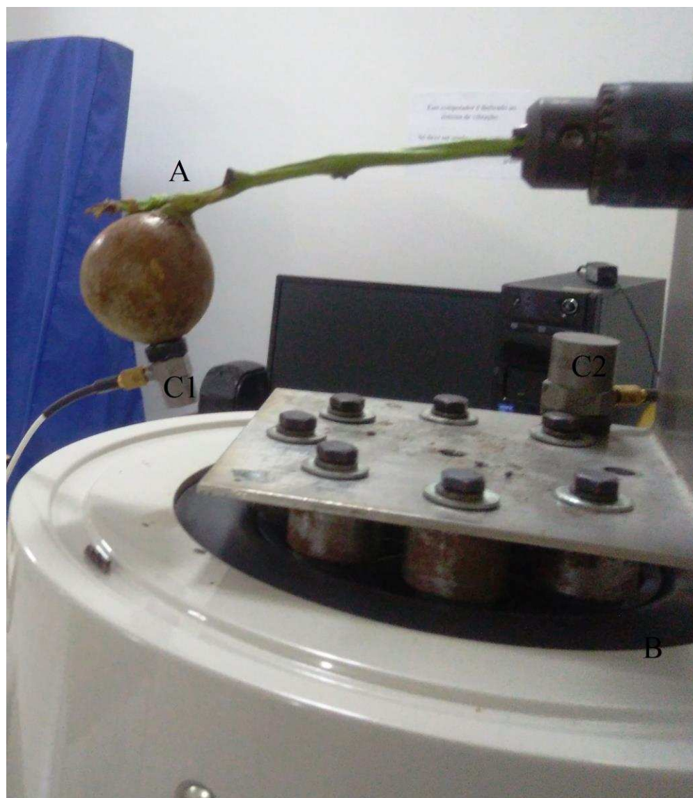
Figura 3: Amostra do sistema fruto-ráquila da macaúba (A) engastado na extremidade oposta ao fruto, para realização do ensaio de vibração utilizando um vibrador eletromagnético (B) e acelerômetros de alta sensibilidade responsáveis por mensurar a aceleração do sistema (C1) e controlar as especificações do ensaio (C2).
