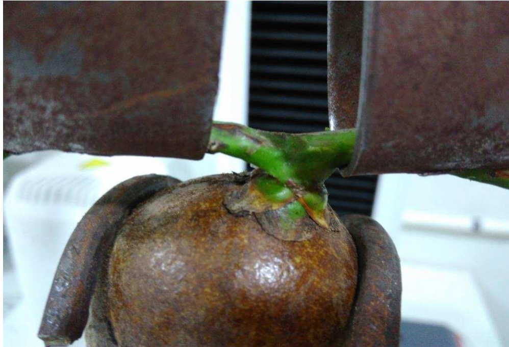
Figura 14: Medições da força necessária para o destacamento do fruto da macaúba, realizadas com o auxílio da máquina de ensaio universal da marca Instron, modelo 3365.
