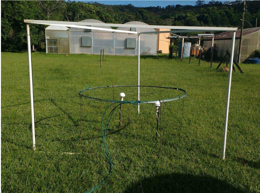
Figura 1 – Estrutura triangular fixa a três hastes metálicas de 1,5 m de altura fixadas ao chão para ajuste do sistema de injeção de CO 2 nos sistemas MINI FACES.
