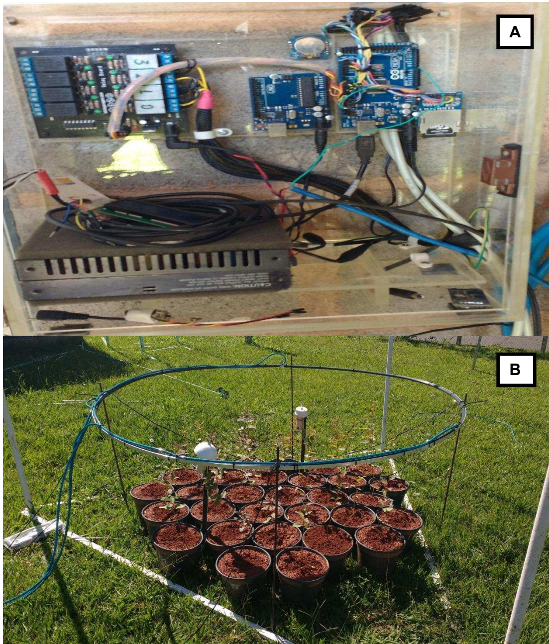
Figura 2 – Circuito elétrico do MINIFACE (A) e demonstração do anel de injeção de \text{CO}_2 dividido em três seções (B).
