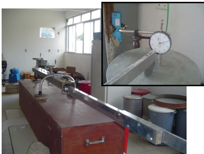
Figura 3.7 – Viga Benkelman sendo aferida segundo a DNER – PRO 175/94.
