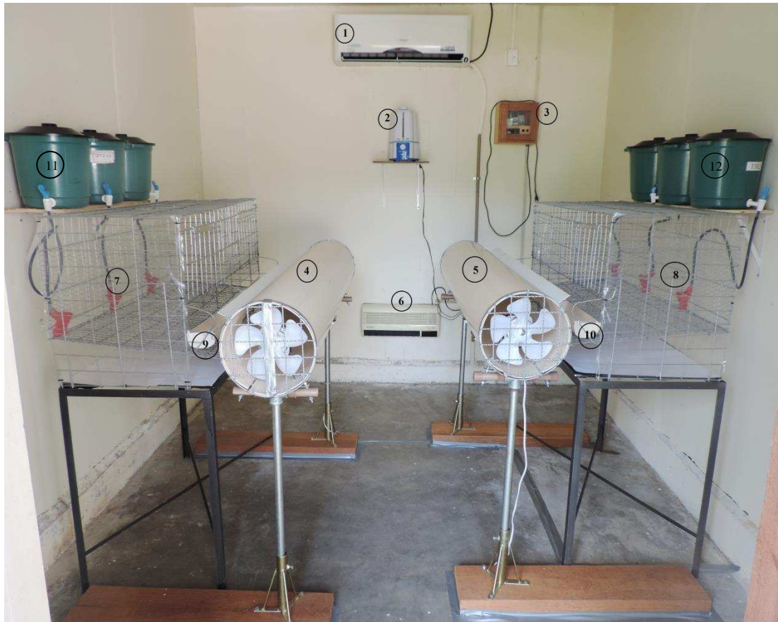
Figura 1.1: Vista interna das câmaras climáticas, onde 1: ar condicionado; 2: umidificador de ar; 3: controlador eletrônico de temperatura e umidade relativa do ar (MT – 531R plus); 4 e 5: tubos de ventilação; 6: aquecedor de ar; 7 e 8: gaiolas; 9 e 10: comedouros; 11 e 12: reservatórios de água.
