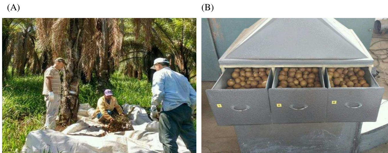
Figura 1- (A) Colheita dos Cachos de Macaúba; (B)- Secador de camada fixa com bandejas
