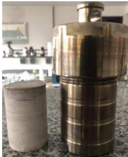
Figura 11 - Autoclave de aço inoxidável e tubo de teflon para síntese dos carbon dots via processo hidrotérmico.
