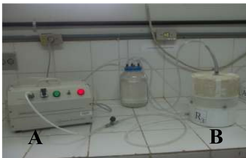
Figura 3. Gerador de ozônio (A) e câmara de exposição dos insetos ao gás O_3 (B).
