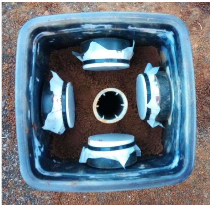
Figura Suplementar 1. Disposição dos anéis de PVC (2,5 x 5 cm de altura e diâmetro) em um vaso retangular com capacidade de 4,5 dm 3 , preenchido com Latossolo Vermelho-Amarelo distrófico (LVAd1) de textura franco-argilo-arenosa. Em cada vaso, foram inseridos horizontalmente oito anéis de PVC sendo dispostos dois em cada lado do vaso, cada um contendo 50 g de Latossolo Vermelho-Amarelo distrófico (LVAd2) de textura muito argilosa.
