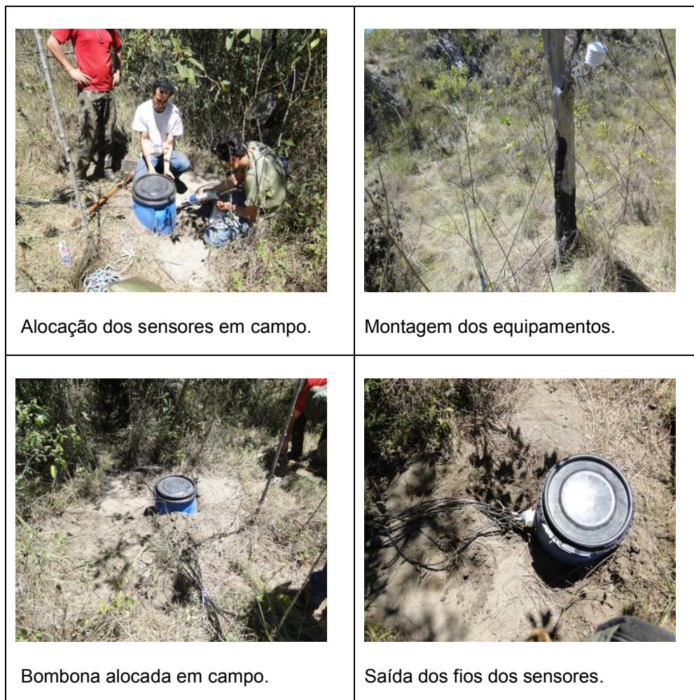
Figura 7: Montagem dos sensores para monitoramento térmico e hídrico em Campo Rupestre Ferruginoso e Campo Rupestre Quartzítico no Quadrilátero Ferrífero, MG.
