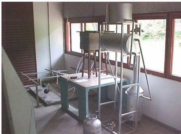
Figura 5 – Vista geral do sistema de avaliação do comportamento térmico das placas
