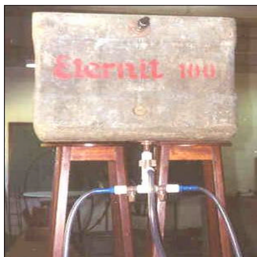
Figura 4 – Montagem do sistema de circulação de água nas placas.
