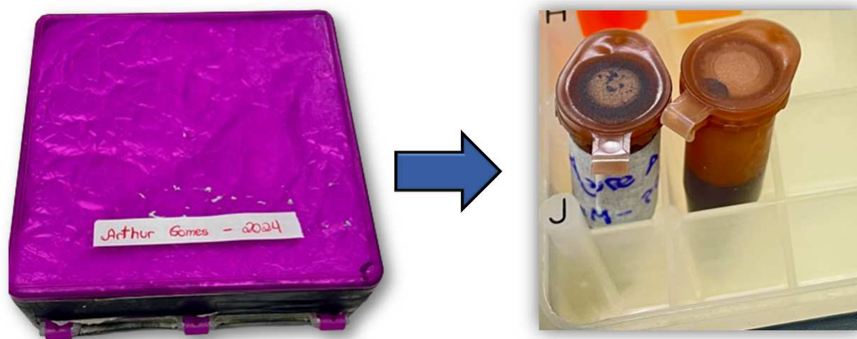
Figura 7.4: Porta amostras utilizados na armazenagem do corante Azure A, à esquerda a caixa revestida por papel alumínio e direita microtubos translúcidos. Fonte: Próprio autor.
