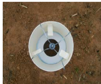
Figura 2A. Representação esquemática detalhes da câmara de captura de amônia e das unidades coletoras de amônia (espumas de nylon).
