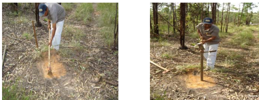
Figuras 10a e 10b. Detalhe da amostragem de solos.
