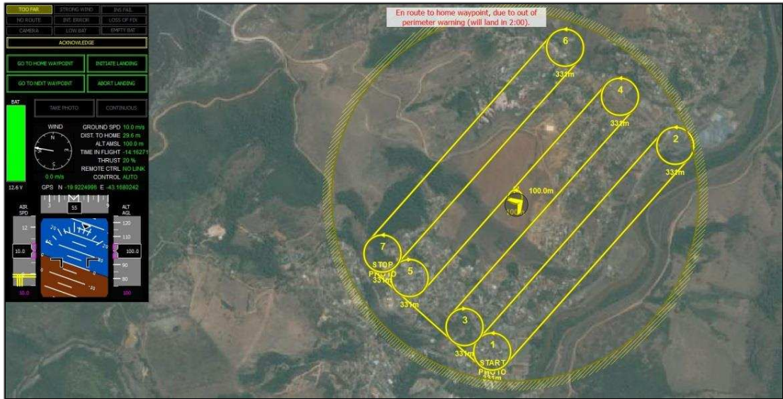
Figura 24. Plano de voo criado, a partir do Ponto 1, para a programação do VANT utilizando o software de controle (eMotion 2).
